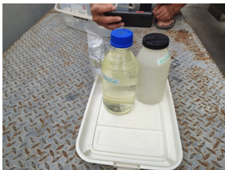
เก็บตัวอย่างน้ำจากหอผึ่งเย็น น้ำเข้าระบบ และอ่างรองรับน้ำ
